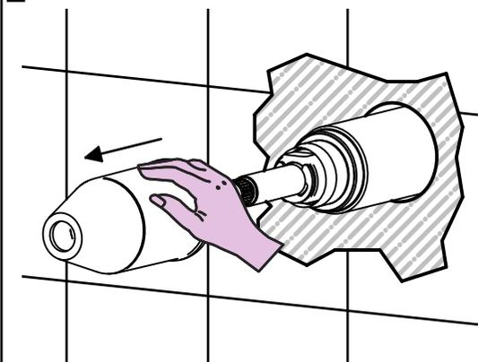
Per installatore: Al fine di garantire la durata del prodotto installare rubinetti con filtro da pulire periodicamente. Effettuare risciacquo delle tubazioni prima di installare il prodotto (PUNTO 1)
